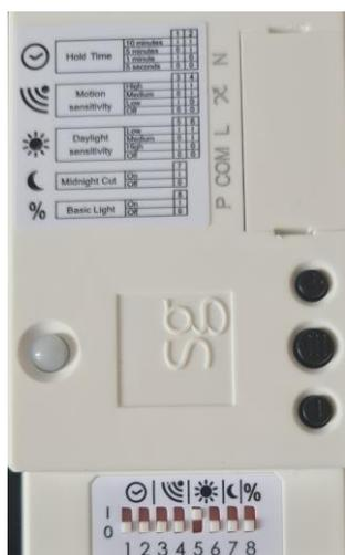
Schritt 1: Stellen Sie alle Dip-Schalter auf Position 0
