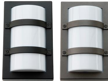
Design: Hallvard Jakobsen. Viereckige Wandleuchte mit zusätzlichem Schutz der Abdeckung. Aus pulverlackiertem Druckgussaluminium. Abdeckung aus UV-beständigem Polycarbonat. Zwei Kabeleinführungen, Möglichkeit für sichtbare oder verborgene Kabelführung, sowie Steckklemmen mit der Möglichkeit zur Durchverdrahtung.
